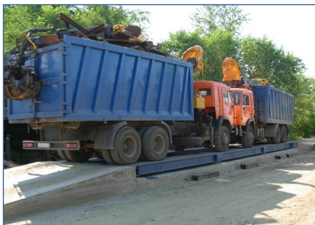
Рисунок 5. Платформа для измерения массы автомобиля
