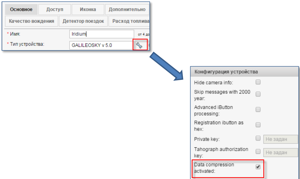
Рисунок 7. Активация приема сжатых данных, передаваемых через канал Iridium, на сервере мониторинга Wialon Hosting
